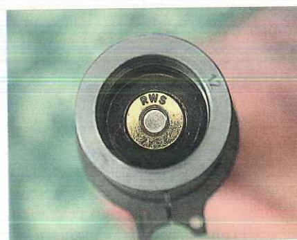
L'estensione posteriore della canna mostra la sede di Rws inserita nella camera di cartuccia
